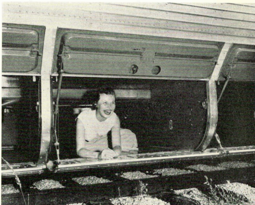
I GM's nye letvægtstog vil man ikke blive generet af bagageopstabling i gangene, mellem sæderne eller i overbelastede bagegenet — bagagen anbringes direkte fra perronen i let tilgængelige, støvtætte rum under waggonerne gulve.
